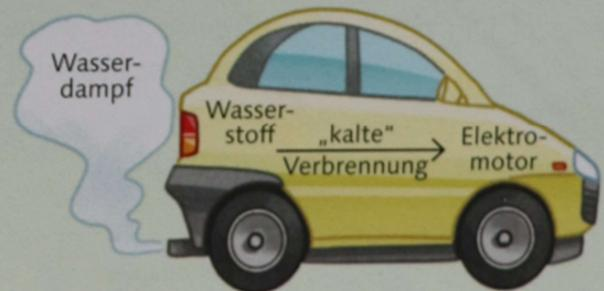
7 *Autos, die mit Brennstoffzellen betrieben werden, erzeugen Wasser als Abgas.*
